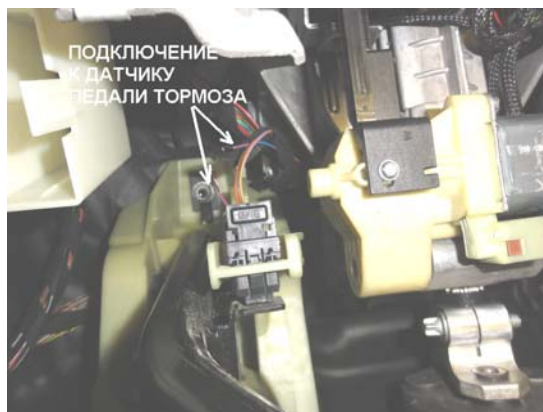
Рис. 3. Место подключения к датчику педали тормоза
